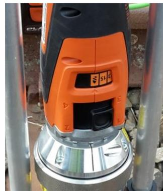
RailTorque è fornito con doppia batteria da 5Ah e caricabatterie 230V. Sono disponibili su richiesta bracci di reazione con misure specifiche
